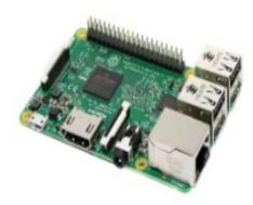
Fig. 1 Raspberry pi3 B+ module
